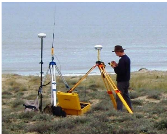
Illustration 13 : DGPS Trimble R6 (base GPS sur le trépied jaune à droite, station mobile sur la perche noire à gauche et antenne radio sur le trépied blanc et bleu au centre).
