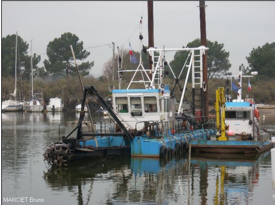
Document 15 : La drague aspiratrice stationnaire "Moutchalette" et de son remorqueur "Mapouchet". Cliché : MANCIET Bruno.
