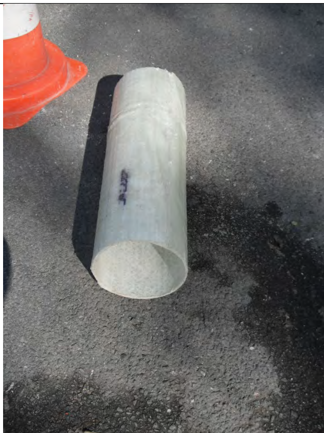
Vue d'un tronçon de chemisage
