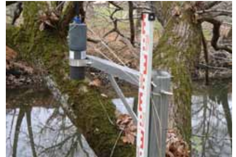
Echelle limnimétrique et capteur de hauteur de la LEYRE
