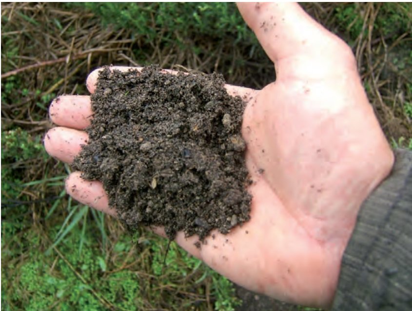
Remblais de tranchée avec sédiments de dragage
