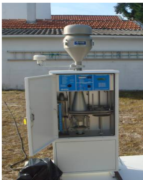
Figure 5 : Préleveur de particules atmosphériques à haut débit
