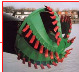
Figure 12 : Drague type Beaver et son cutter (source IHC)
