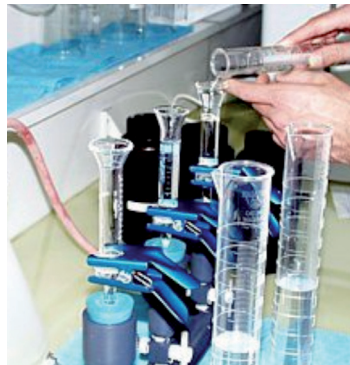
Rampe à filtration pour l'analyse de la Chlorophylle (crédit Ifremer).
