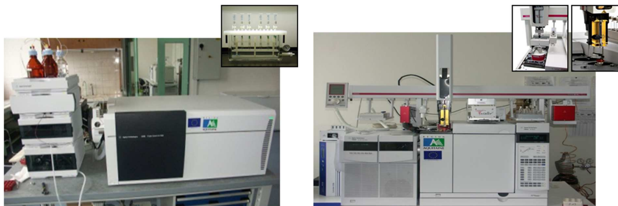
Figure 3 : Techniques d'extraction et d'analyse utilisées pour la quantification des pesticides suivis dans REPAR (SPE-LC/MS/MS à gauche et SPME/SBSE-GC/MS/MS à droite)
