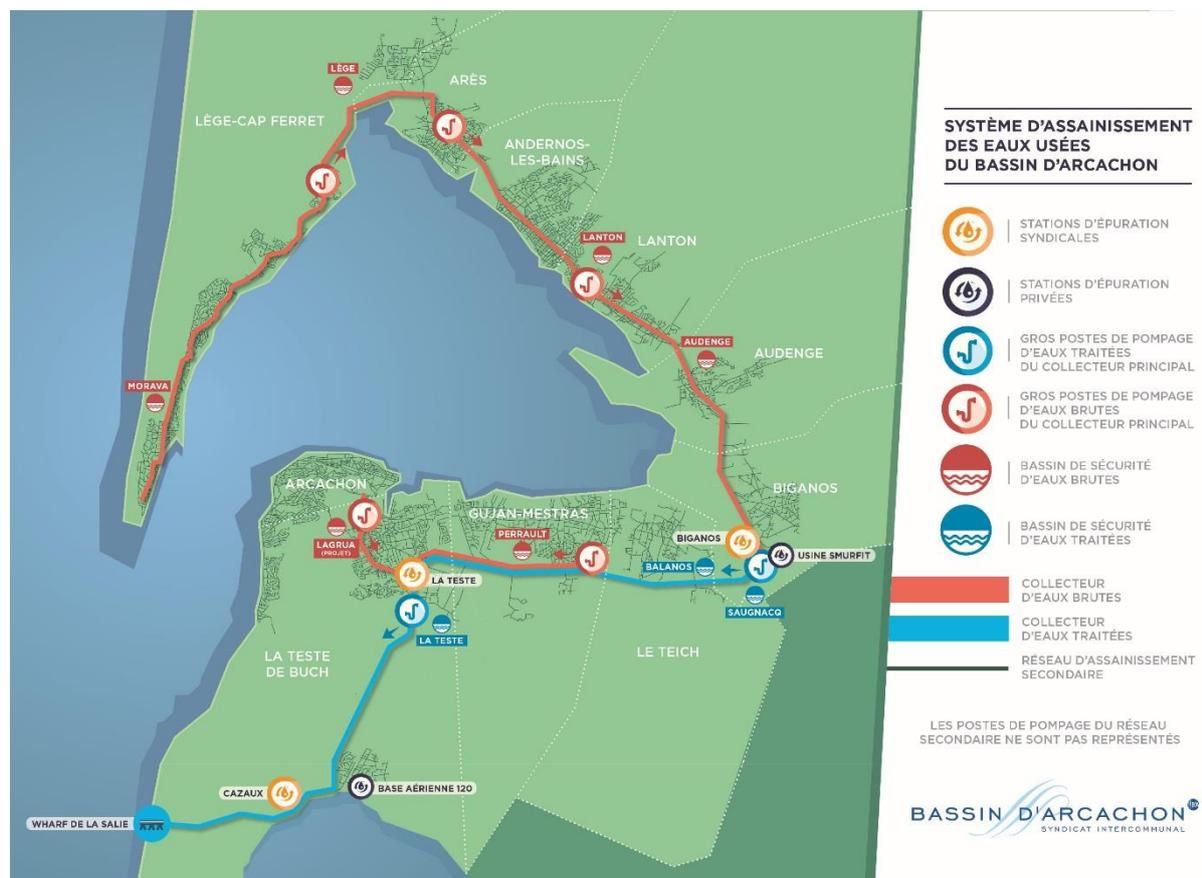
Figure 1 : Schéma général du réseau d'assainissement autour du Bassin d'Arcachon.
