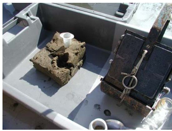
Figure 4 : Prélèvement à la benne Eckman, avec sous échantillonnage de la méiofaune
