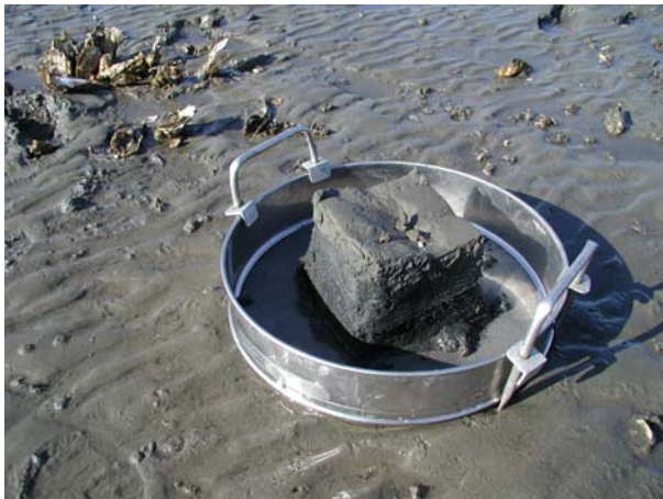
Figure 12 : Bloc de sédiment : les trois premiers cm correspondent à un nappage de sable, reposant sur des sédiments souvent fins et instables.
