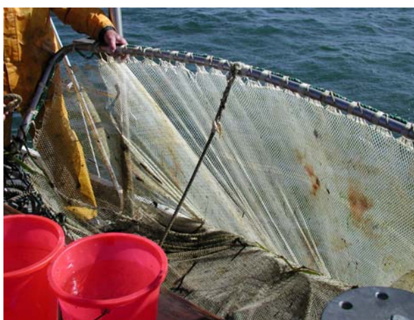
Figure 5 : Drague à crevettes pour prélèvements en herbier.
