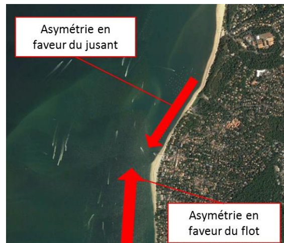
Figure 31. Schéma de principe de l'asymétrie des courants de marée au Nord et au Sud de la jetée du Moulleau.
