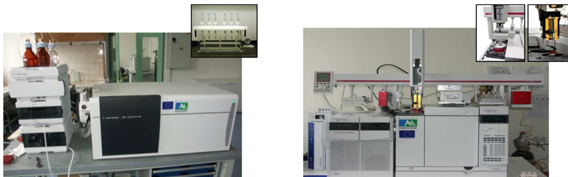
Figure 3 : Techniques d'extraction et d'analyse utilisées pour la quantification des pesticides suivis dans REPAR (SPE-LC/MS/MS à gauche et SPME/SBSE-GC/MS/MS à droite)
