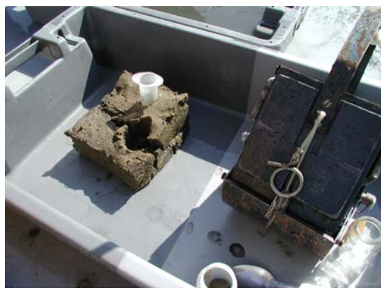
Figure 5 : Prélèvement à la benne Eckman, avec sous échantillonnage de la méiofaune
