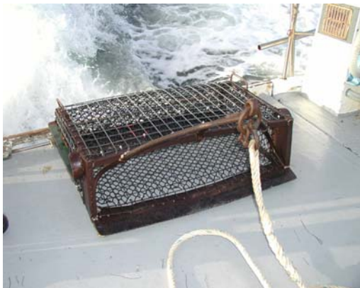
Figure 6 : Drague à coquilles
