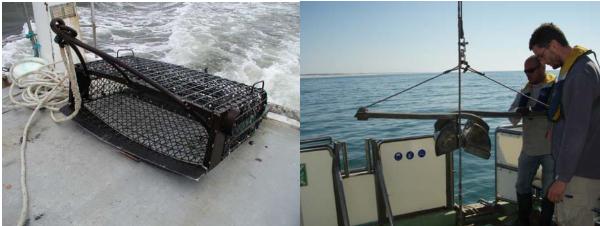
Figure 2 : Prélèvements : drague à coquilles (à gauche) et benne Van Veen (à droite)
