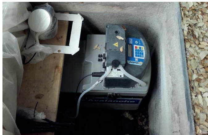
Photo 1. Prélèveur automatique à gauche, prélèvement dans les eaux pluviales à droite.
