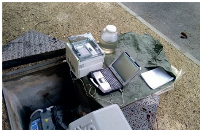
Photo 2. Capteur de hauteur radar et mémographe (à gauche), préleveur automatique et débitmètre (à droite).
