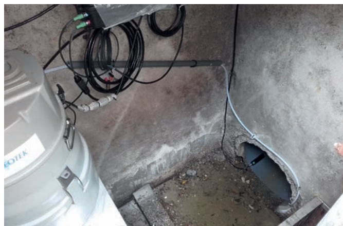
Photo 2. Capteur de hauteur radar et mémographe (à gauche), préleveur automatique et débitmètre (à droite).
