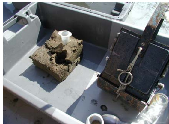
Figure 5 : Prélèvement à la benne Eckman, avec sous-échantillonnage de la méiofaune
