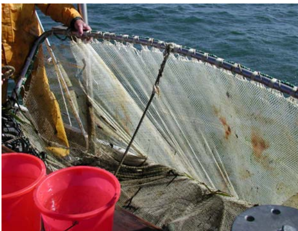
Figure 7 : Drague à crevettes pour prélèvements en herbier.
