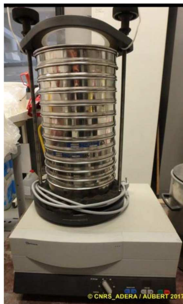
Figure 9 : Colonne de tamis normalisée AFNOR sur tamiseuse Retsch
