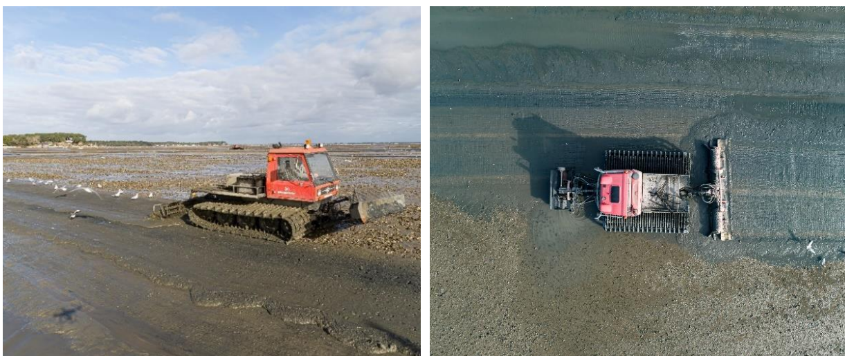
Figure 12 :PETITE DAMEUSE EQUIPEE D'UNE FRAISE A L'ARRIERE (GAUCHE) / GROSSE DAMEUSE EQUIPEE D'UN BROYEUR FORESTIER A L'AVANT ET D'UNE FRAISE A L'ARRIERE (DROITE)
