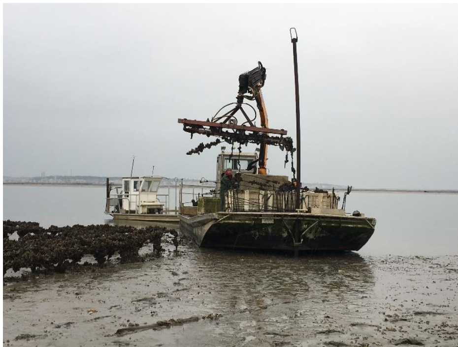
Figure 9 : OUTIL PERMETTANT DE RAMASSER LES POCHEs ET LES FERRAILLES
