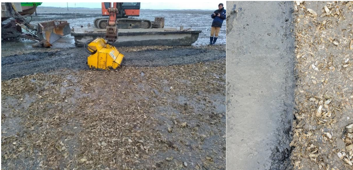
Figure 10 :ESSAI DU BROYEUR FORESTIER SUR MINI-PELLE ET PONTON (GAUCHE) ET RENDU DU JOUR DE L'ESSAI (DROITE)
