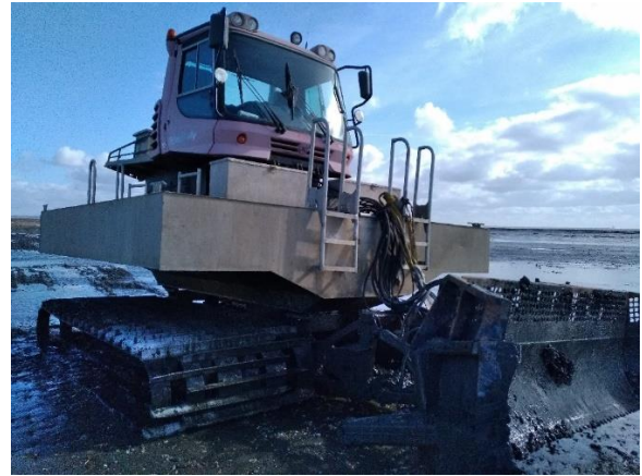
LA DAMEUSE NIVELLE LE TERRAIN
