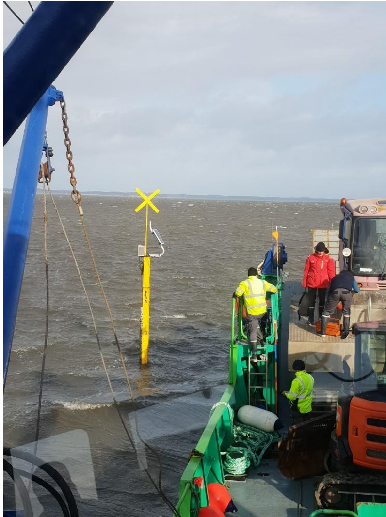
Figure 15 : OPERATION DE MAINTENANCE SUR SONDE
