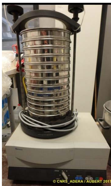
Figure 16 : Colonnes de tamis normalisées AFNOR sur tamiseuse Retsch
