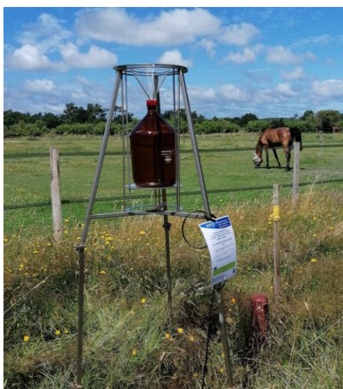
Figure 1 : Jauge HAP installée à la réserve naturelle d'Arès
