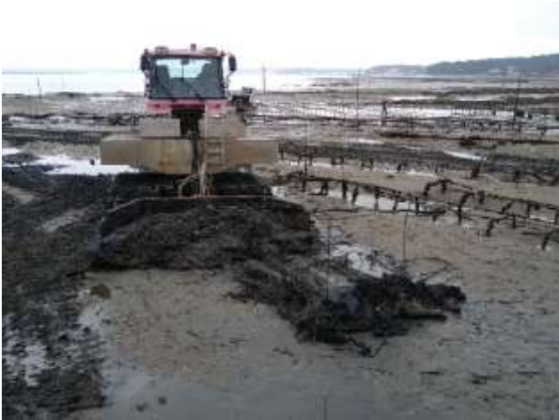
La dameuse qui nivelle le terrain
