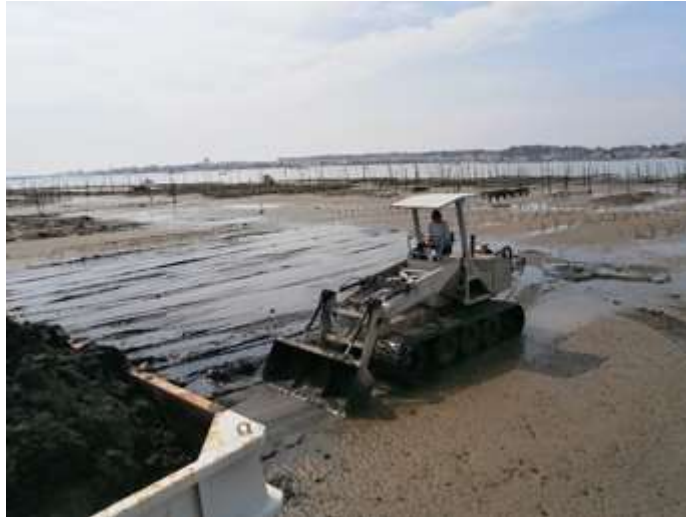
Figure 14 : Bull aplanissant la surface à l'aide de son godet
