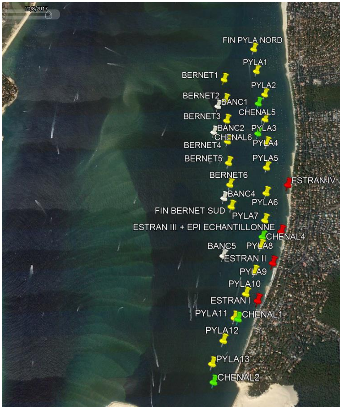
Figure 1 : Localisation des prélèvements (fond de carte : Google Earth). En jaune (BERNET et PYLA) : à la drague ; en blanc ou vert (CHENAL et BANC) : à la benne Van Veen ; en rouge (ESTRAN) : stations à pied. Les positions sont en Annexes 1 & 2.
