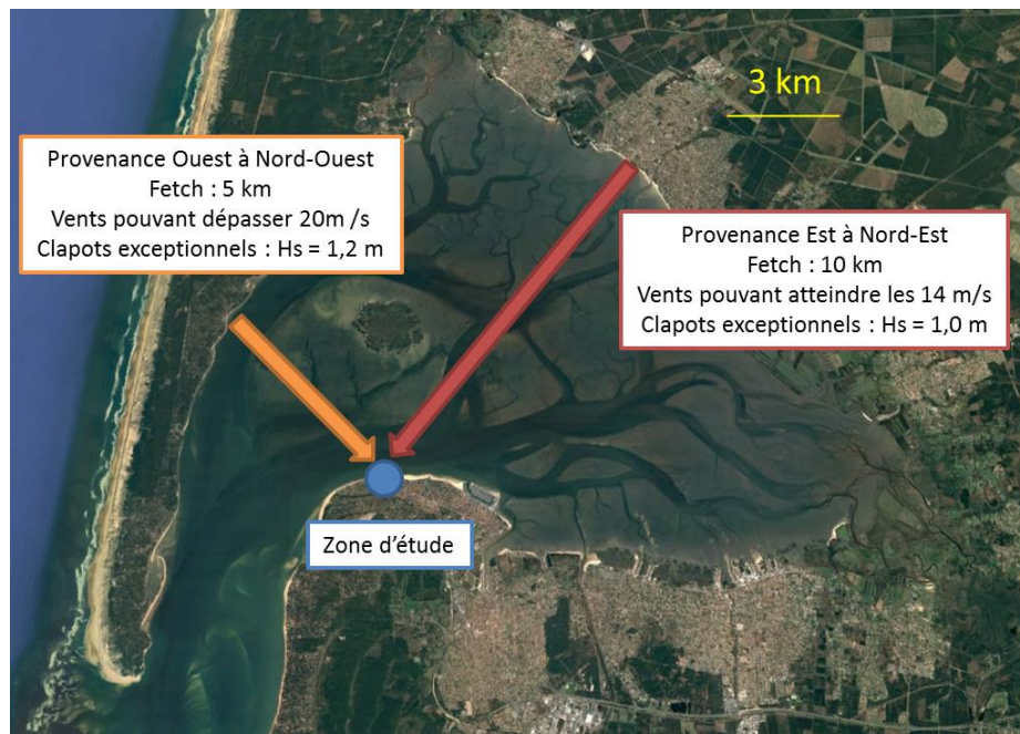
Figure 6. Analyse des clapots sur la zone d'étude selon la méthode SMB 1973
