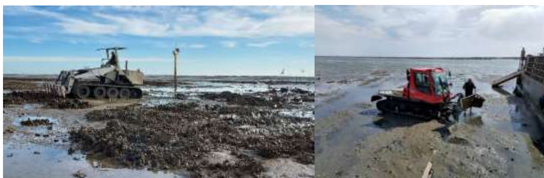
Figure 33 : bull de l'Estey sur des zones plus sableuses et dameuse sur des zones plus vaseuses
