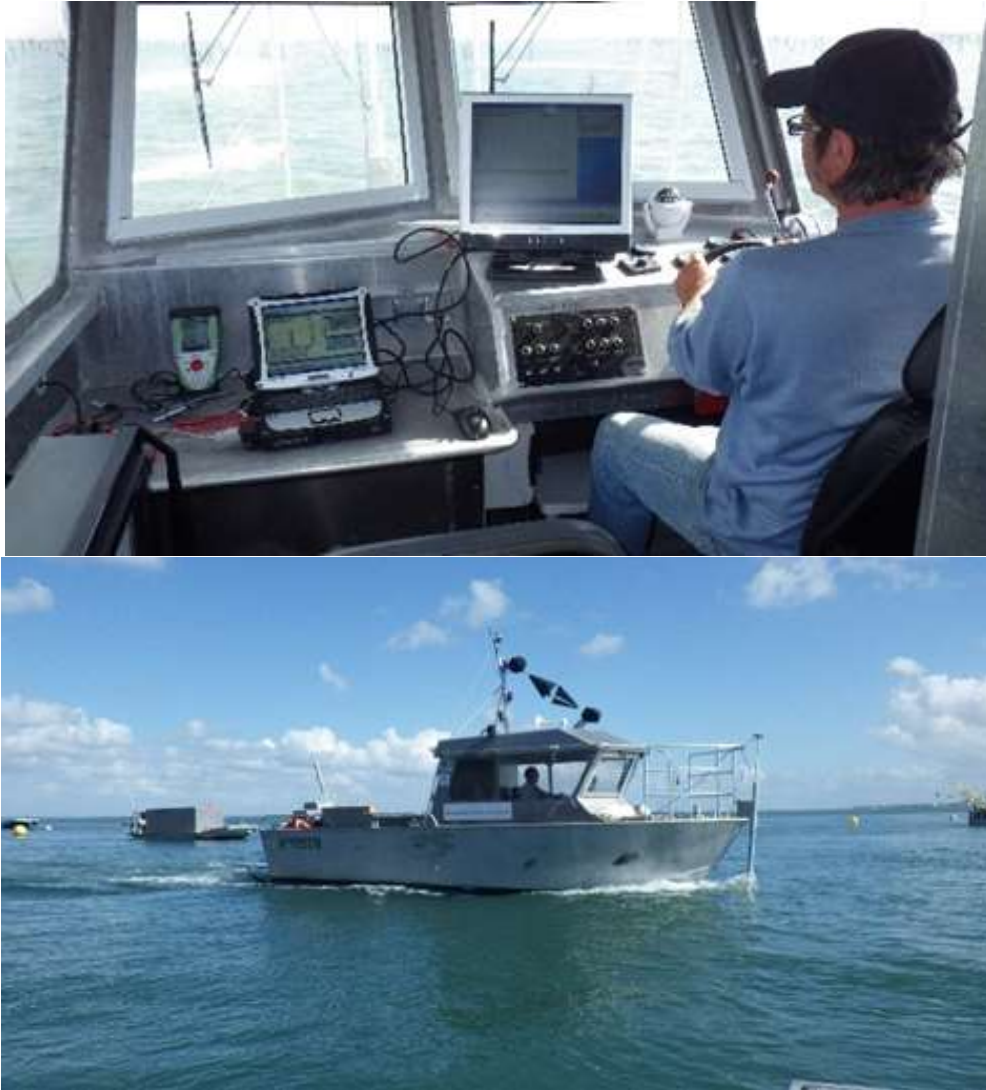
Figure 31 : navire SIBA II et son équipement d'acquisition de données de bathymétrie
