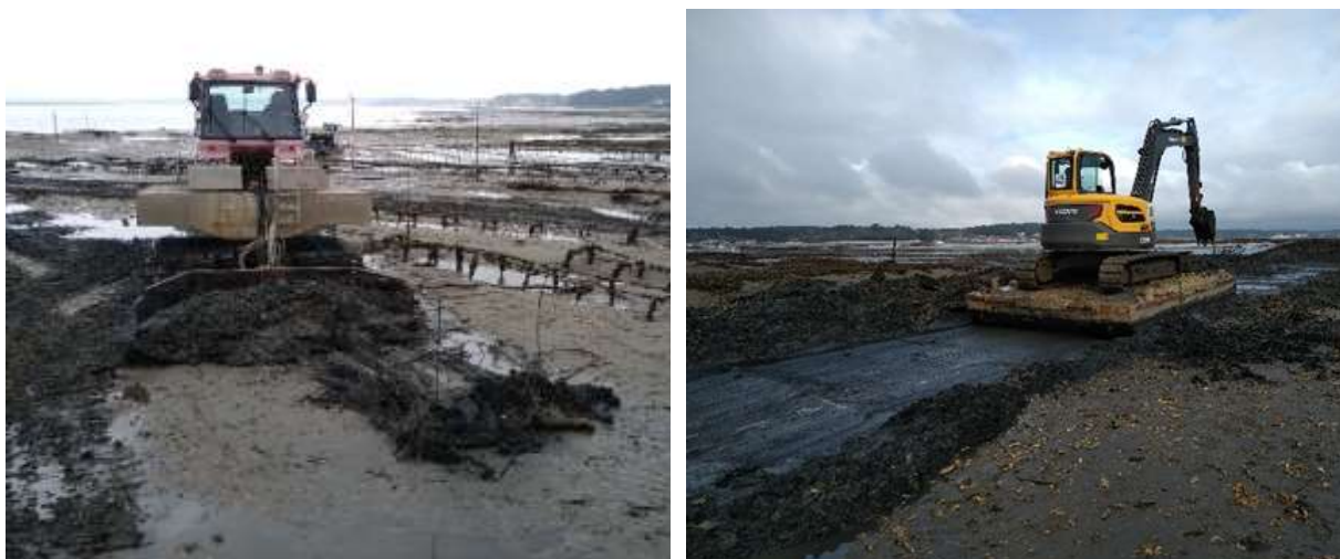
Figure 28 : dameuse marinisée et pelle sur ponton du département de Charente Maritime
