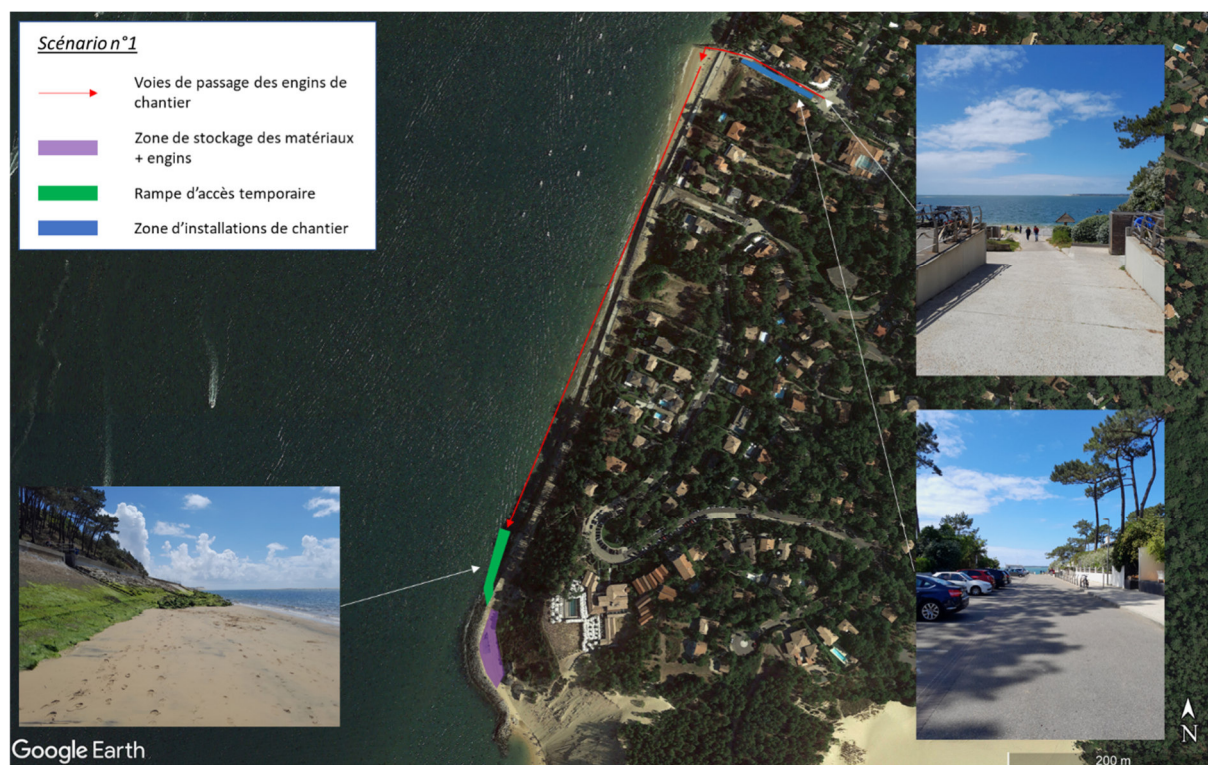
Figure 16 : Proposition du scénario d'implantation des installations de chantier, zones de stockage et circulation pour accès et travaux au musoir
