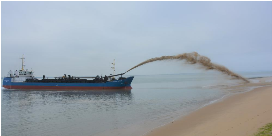
Figure 13. Drague aspiratrice « Côte de Bretagne » réensablant les plages du Pyla-sur-Mer (© Crédit photo : Sabine Menet, Sud-Ouest).
