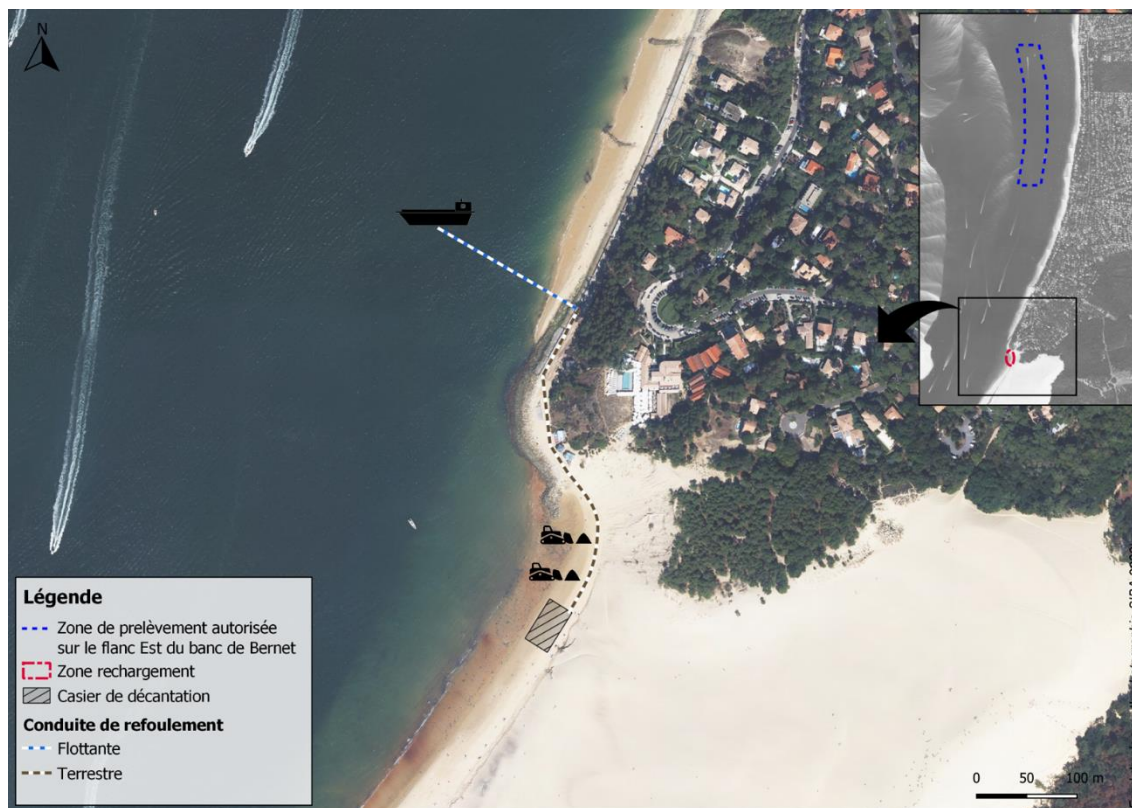
Figure 3. Schéma de mise en œuvre des opérations pour la solution 1.
