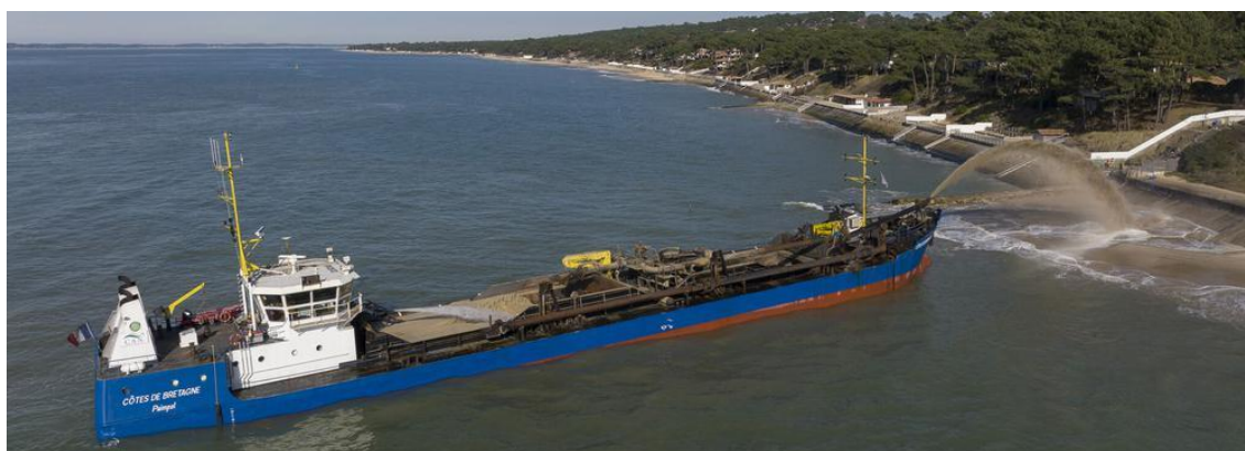
Figure 4. La drague Côte de Bretagne en action de rainbowing lors du rechargement des plages du Pyla-sur-Mer en 2022.
