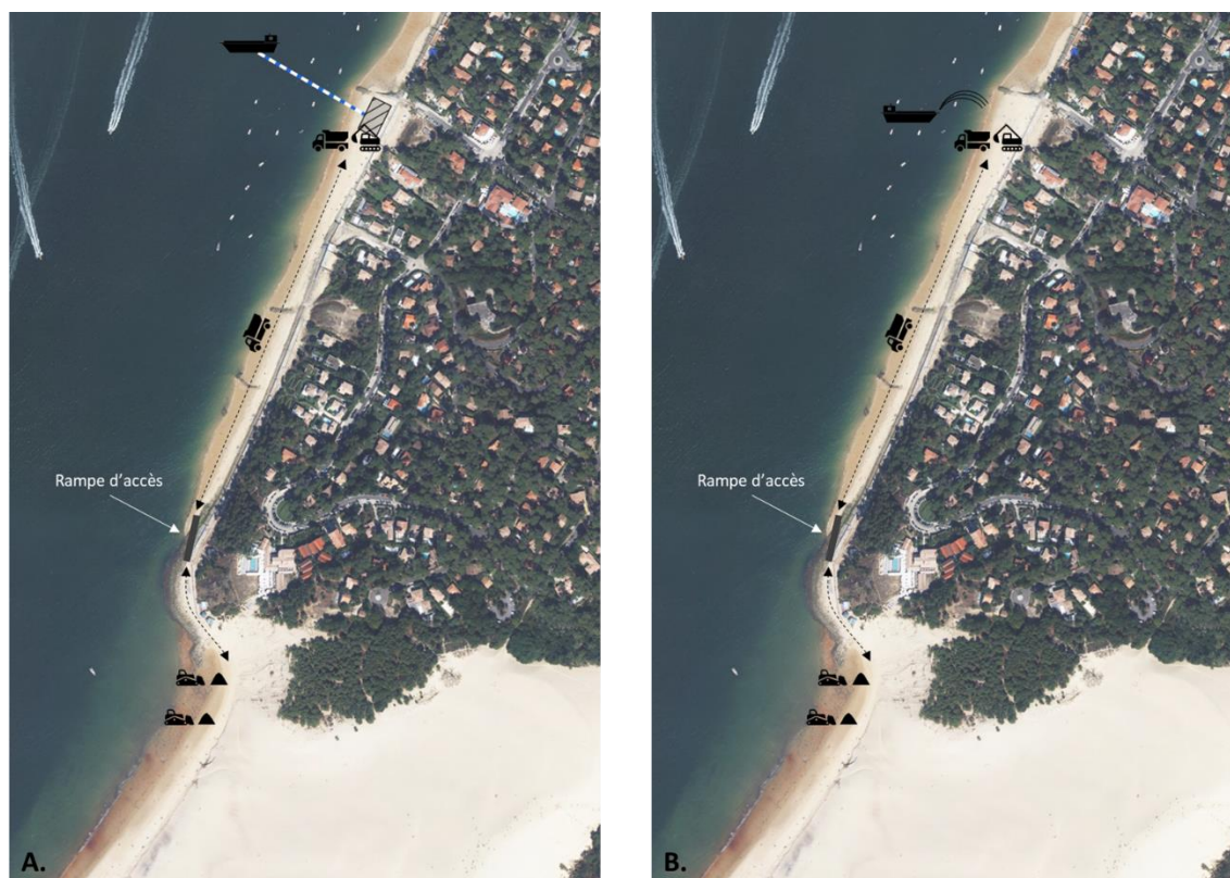
Figure 6. Schémas de mise en œuvre des opérations pour la solution 3 avec A. la variante conduite et B. la variante rainbowing.
